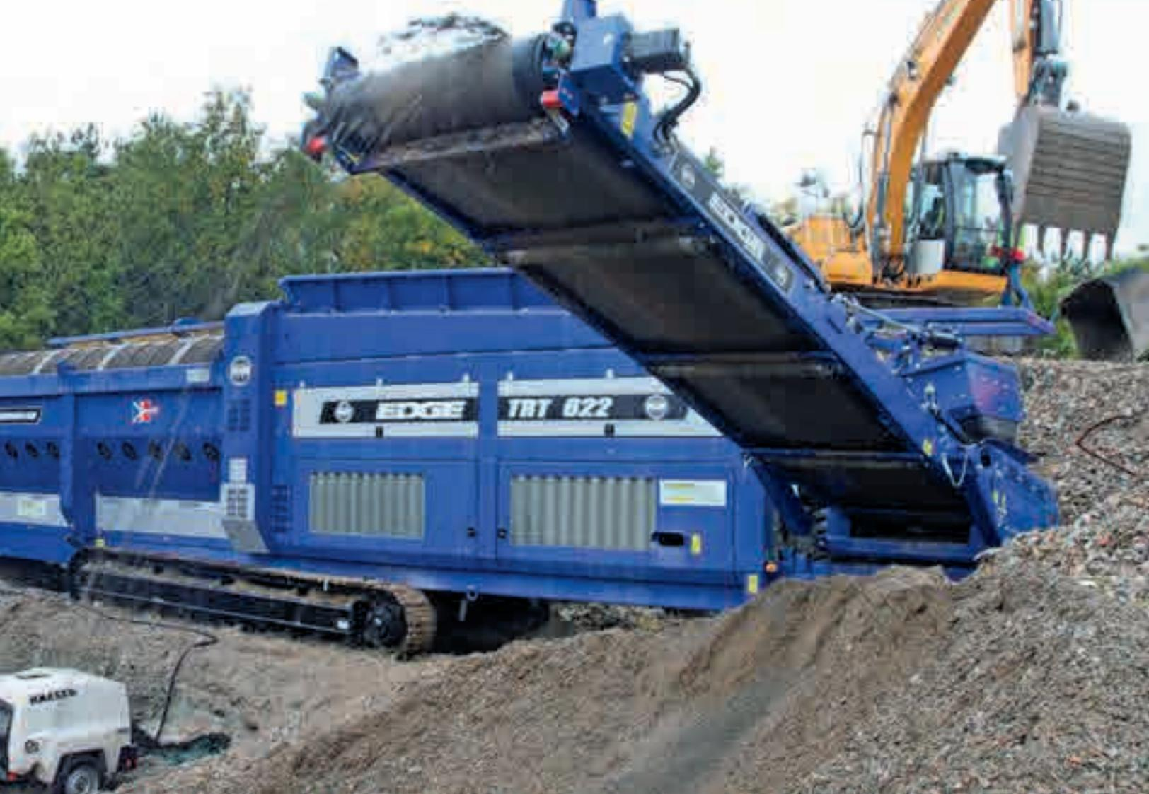
La fraction 20/80 est traitée par un trommel Edge TRT622 et un tri aéraulique Edge MC1200, ce dernier sépare la fraction légère (A) et la fraction lourde (B).
