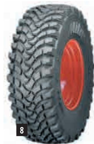
rapport aux pneus radiaux standards gonflés à la même pression, ou pour transporter la même charge avec une pression de gonflage inférieure de 20%. La même dimension 710/70R42 est introduite pour le modèle A550 Multiuse M+S, pneu agro-industriel avec ceinture acier et profil à pavés (en photo). Enfin, pour les espaces verts, les pneus Galaxy Garden-Pro et Mighty Mow sont désormais disponibles dans les dimensions respectives 420/70R24 et 17.5L24.
