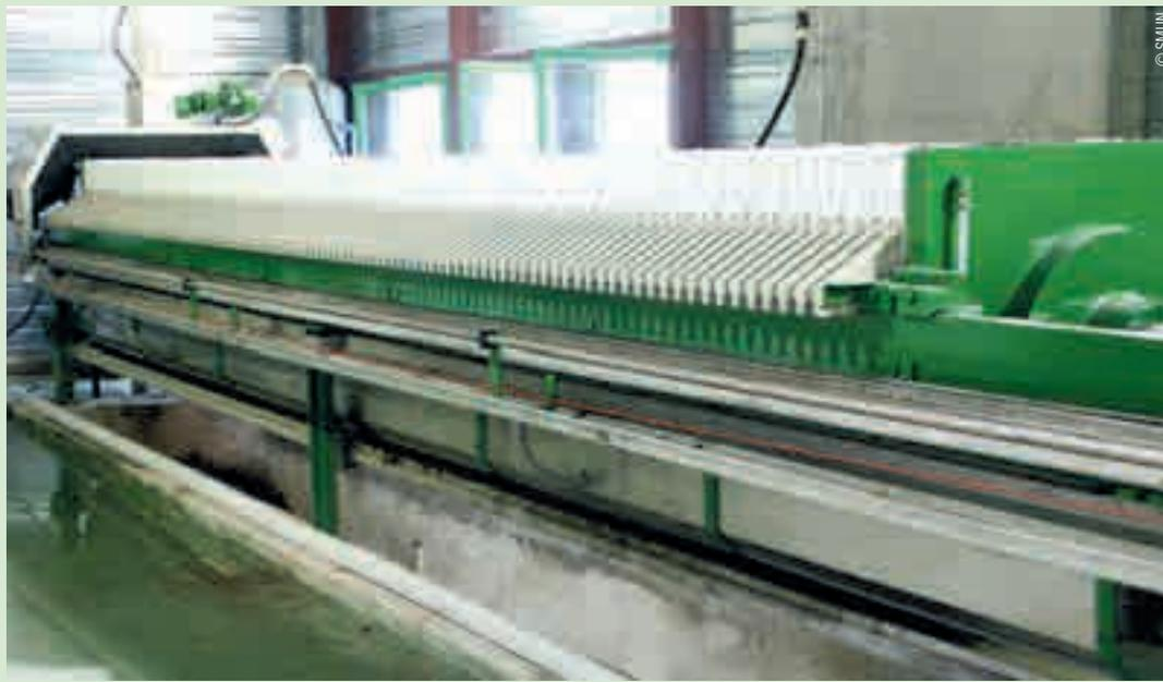
1 - Usine de décarbonatation de Yutz ; déshydratation mécanique des boues calcaires.
